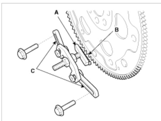
5) 使用两个变速器固定螺栓安装专用工具。牢固拧紧支架和连杆的螺栓和螺母。
