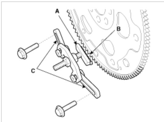
4) 使用两个变速器固定螺栓安装专用工具。牢固拧紧支架和连杆的螺栓和螺母。
