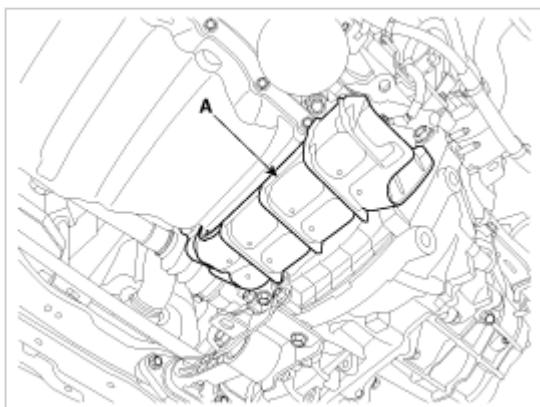
2) 拧下下部曲轴箱底部的2个变速器固定螺栓(A)和维修盖(B)。
